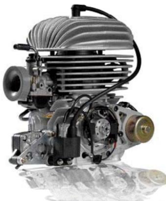
potenza di 8 Cv, costa 1.428 euro (iva inclusa), ha una vita di circa 200 ore: si riesce a fare una stagione con 15 gare e molte sedute di prove, cambiando solo il pistone una volta, prima di doverlo revisionare. Questo propulsore si può montare su qualsiasi telaio omologato per la 60 nazionale, con un costo finale di cir-
